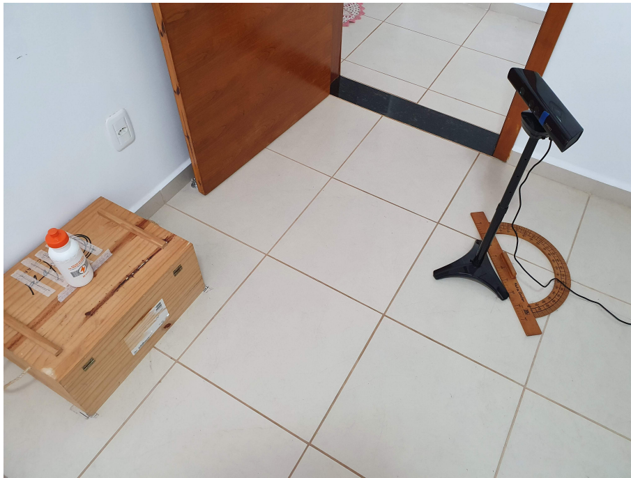
Figura 12 – Fotografia do ambiente de realização dos experimentos. Pode-se observar a haste móvel com o Kinect acoplado, o transferidor de grau usado para medir as rotações da haste sobre o eixo z, além do objeto-alvo sobre a caixa.
