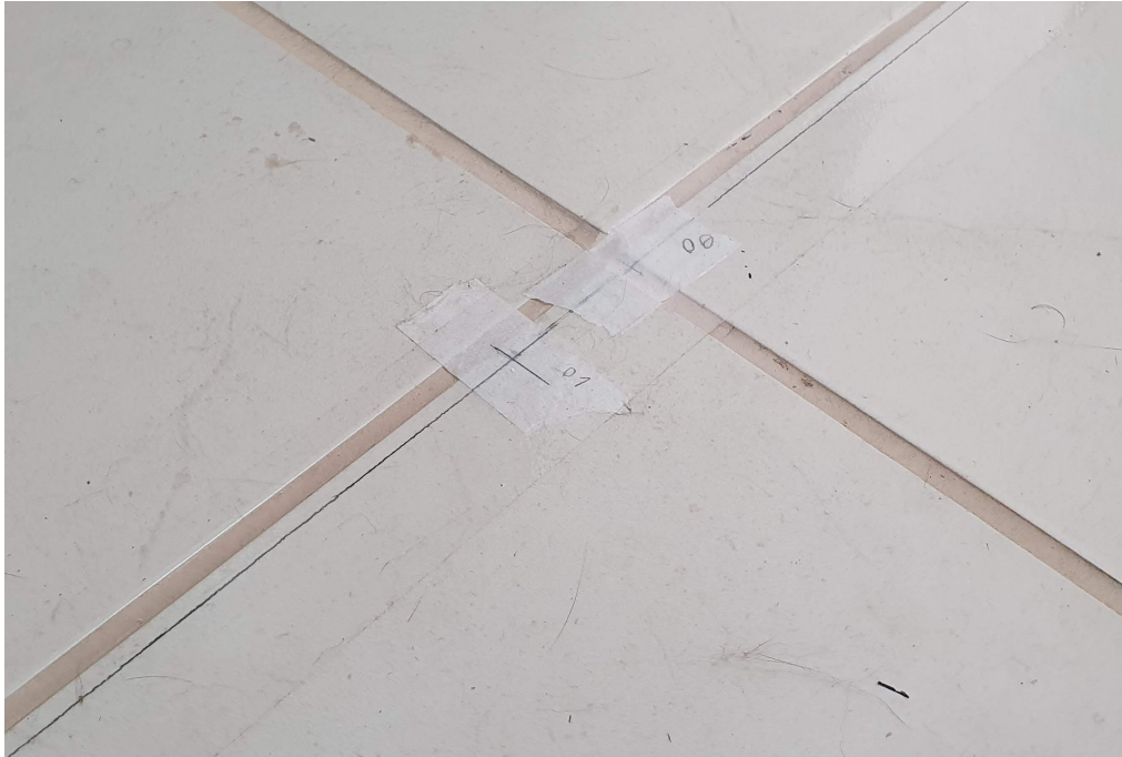
Figura 15 – Marcações feitas no ambiente de realização dos experimentos destacando os pontos de fixação iniciais de dois experimentos diferentes, identificados com 00 e 01. Além disso, é possível verificar uma linha que foi desenhada para demarcar o eixo y do sistema de coordenadas de ambos os pontos.
