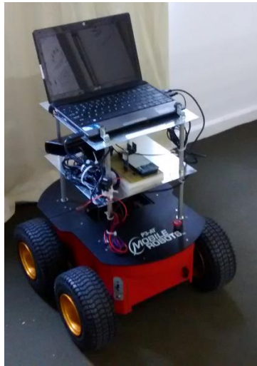
Fig. 1. Robô Pioneer P3AT, suporte para os sensores (nível intermediário) e notebook (nível superior)
