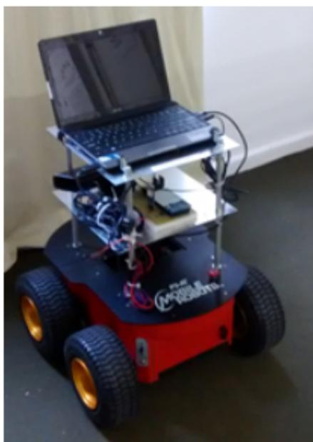
Figura 1. Robô Pioneer P3AT, suporte para os sensores (nível intermediário) e notebook (nível superior)
