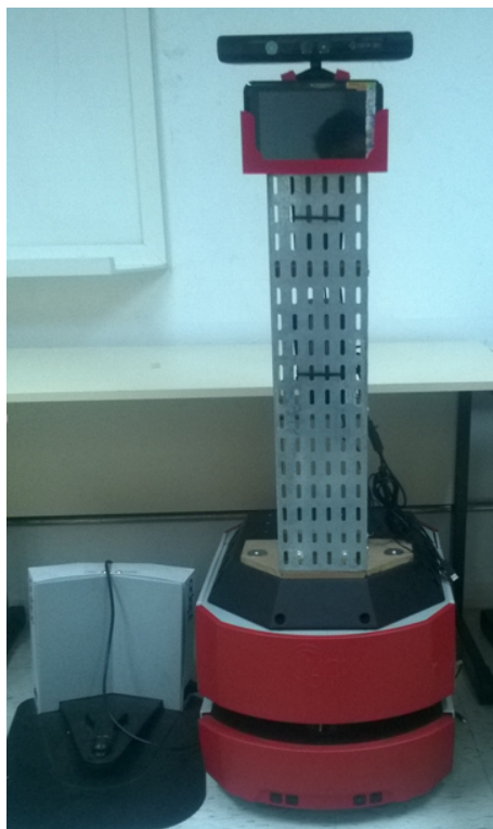
Figura 1. Pioneer LX com suporte e dispositivos extras e sua estação de recarga)
